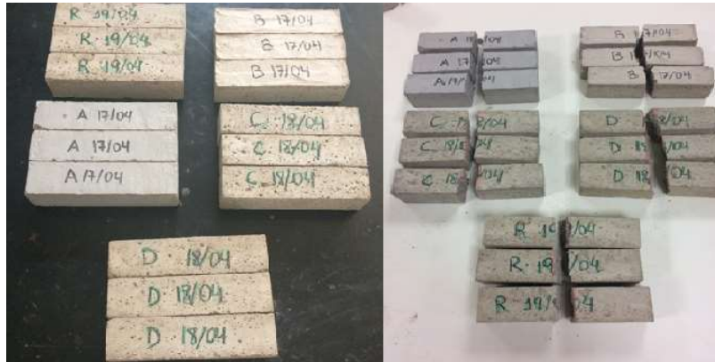
Figura 7 – Moldes antes e depois de serem rompidos à tração na flexão
