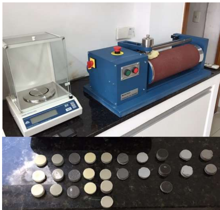
Figura 2.2 - (a) Balança de precisão e abrasímetro de polímeros – (b) Corpos de prova do ensaio de abrasão segundo a DIN ISO 4649
