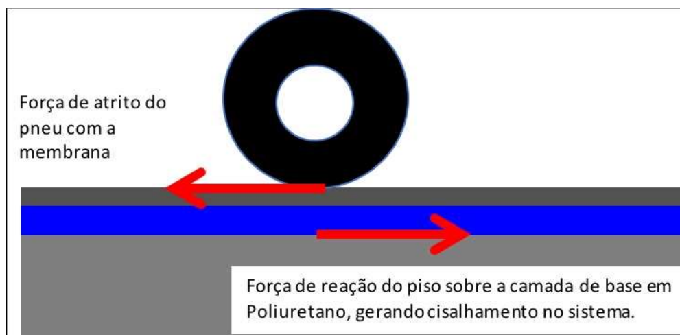
Figura 4.3 - Croqui esquemático do esquema de forças atuantes no ensaio de abrasão por ação de pneus sobre os sistemas com camada base em Poliuretano
