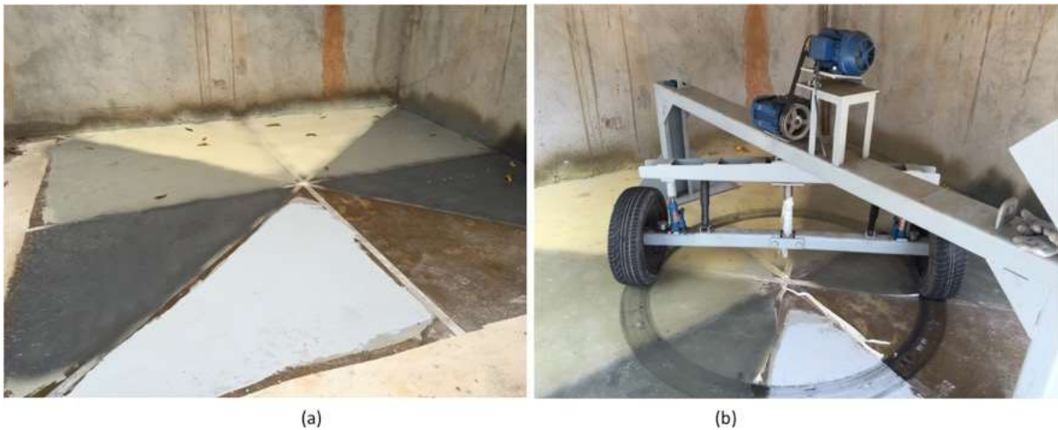
Figura 2.7 – (a) Membranas de poliuréia a quente sobre primer epóxi e também sobre a camada base do sistema de poliuretano e a mambra multicamadas do sistema de poliuretano aplicadas sobre laje de concreto (b) Equipamento de abrasão por atrito de pneus devidamente instalado para a execução do ensaio.
