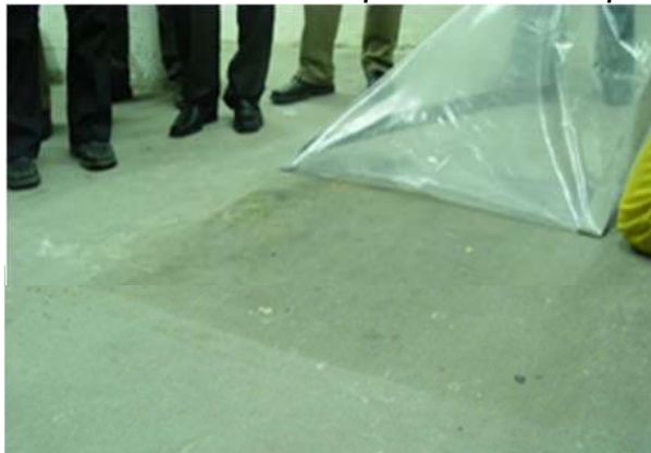
Figura 11 – Teste de umidade superficial com filme plástico
