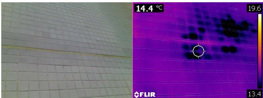
Figura 8 – Ensaio de termografia em fachada
