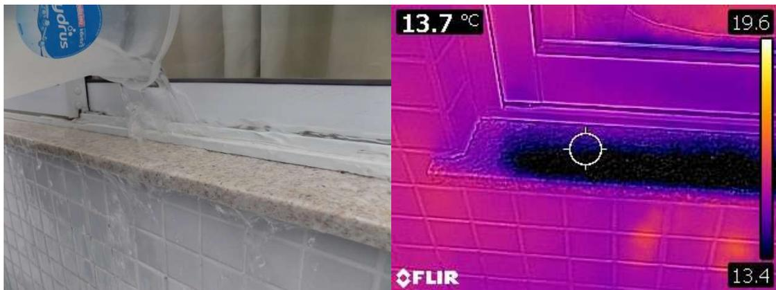
Figura 7 – Ensaio de termografia em soleira da janela
