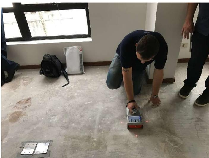
Figura 9 – Equipamento de escaneamento por radar. (Autor, 2017)
